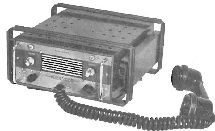
Fig. 47 - Ricetrasmittitore per automezzi costruite dalla Nuclear S.p.A., modello N 562.
