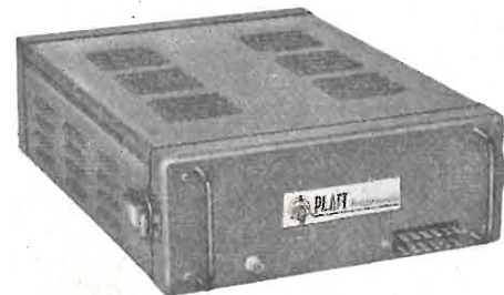
Fig. 35 - Ricetrasmittitore mobile «Platt 450-470» per UHF costruito dalla Platt Manufacturing Co.
