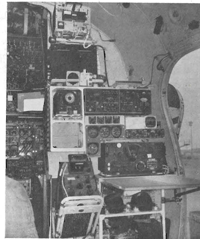
Ecco come si presenta (a sinistra) il posto di pilotaggio di uno tra i più moderni velivoli di linea: un DC-7C della SAS (Scandinavian Airlines System). Aspetto altrettanto complicato ha il posto del navigatore sullo stesso DC-7C della SAS (a destra). In esso sono installati un ricevitore Loran, due radiogoniometri, un BC348, diversi altri apparati di radioassistenza al volo.
